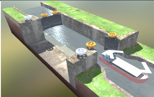
Bateau dans le sas, fermeture des portes et des vannes
