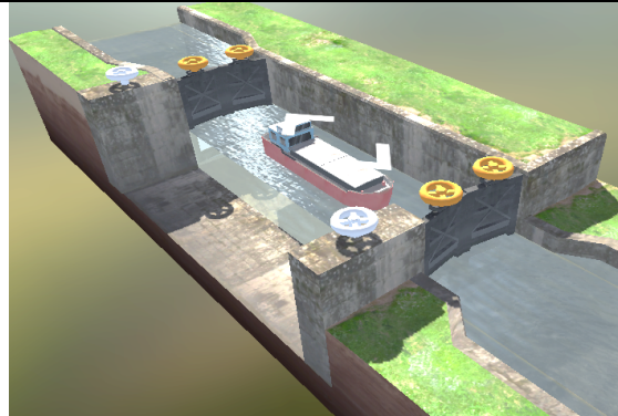
Ouvertures des vannes, descente du niveau d'eau jusqu'à équilibre avec l'aval.
