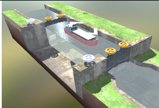
Bateau dans le sas, fermeture des portes et des vannes
