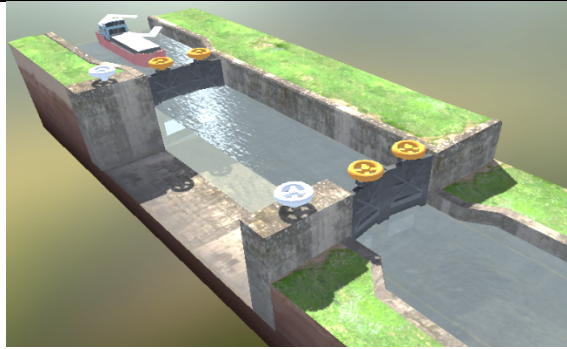
Arrivée du bateau en amont, ouverture des vannes entre l'amont et le sas.
